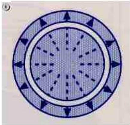
Mittels Fußpumpe die Luftkammer der ausgelegten Hülle aufpumpen.
